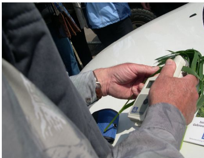
Рис.10. Прибор для определения потребности растений в азотных удобрениях по интенсивности окраски листьев
